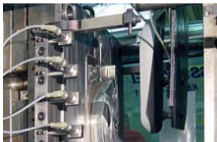
Contrôle de démoulage
